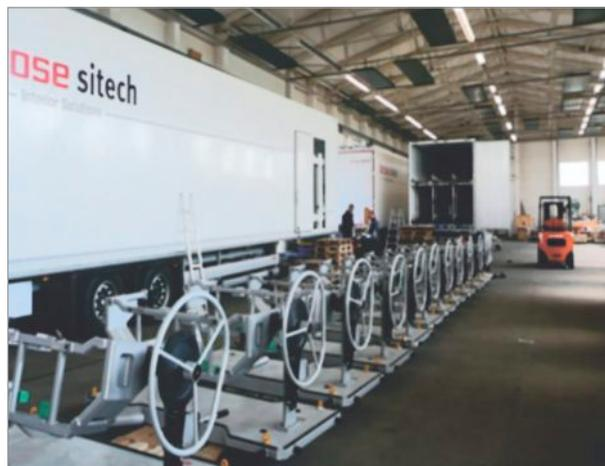
Abb.5: Eine Einheit von 10 Förderanlagen vor dem Einbau in einen Trailer
